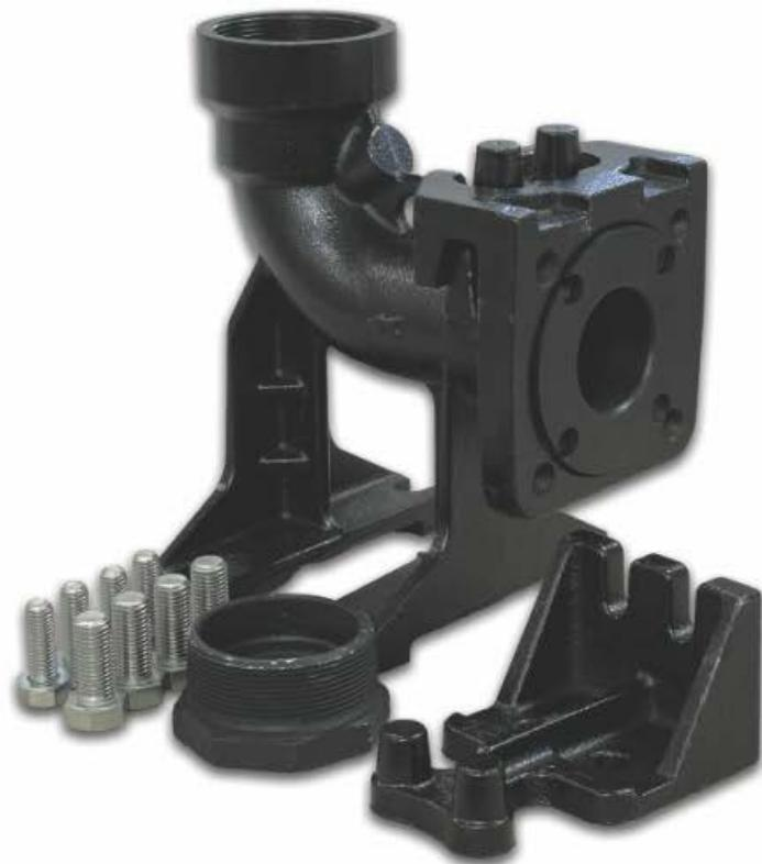
Estos codos están diseñados para instalarse en cárcamos húmedos o tanques, permitiendo retirar la bomba para su mantenimiento y servicio sin que el personal tenga que ingresar al cárcamo o tanque ni desmontar la brida de la bomba conectada a la tubería.
